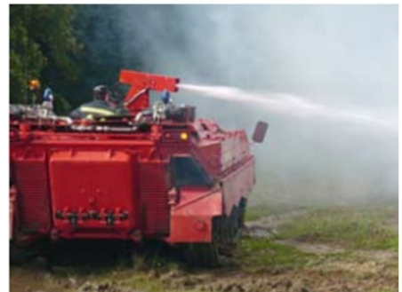
Teknik pemadam api vorteks bertekanan tinggi: kapasitas pemadam tinggi dengan penggunaan air yang sedikit memungkinkan otonomi kendaraan yang besar.
