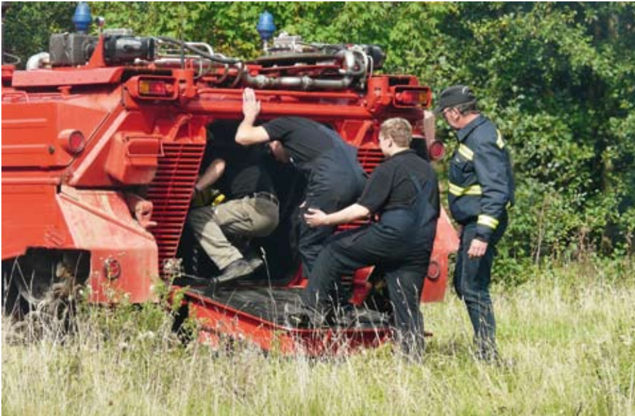
Nach Entleeren der faltbaren Tanks können 20 bis 30 Personen sicher aus der Gefahrenzone evakuiert werden.
